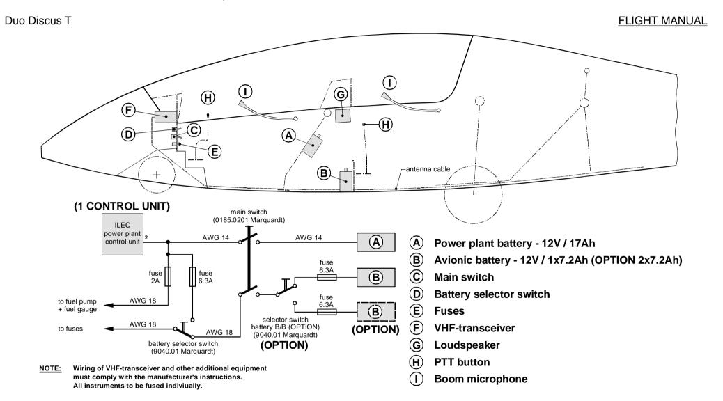
ELECTRICAL SYSTEM - AVIONICS M08 RE 811
